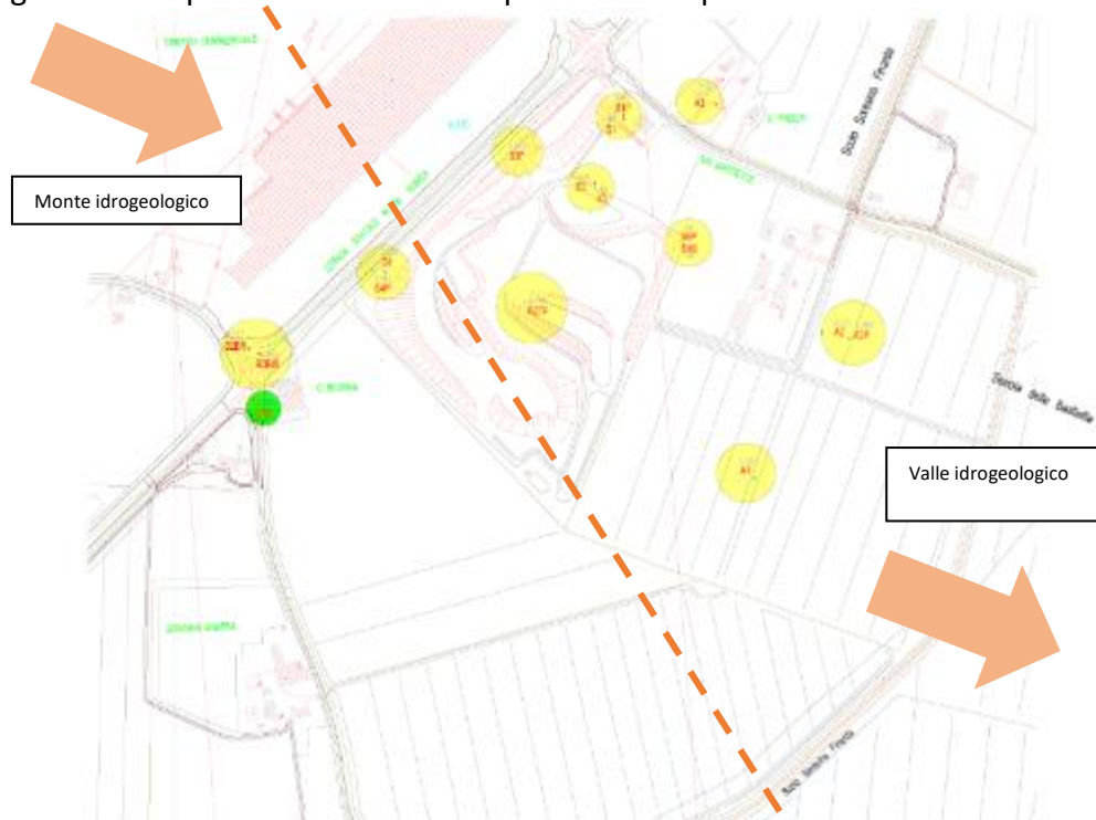
Figura 13: Ubicazione dei piezometri con il loro codice identificativo su Carta Tecnica Regionale e l’indicazione di massima dell’andamento della falda.
