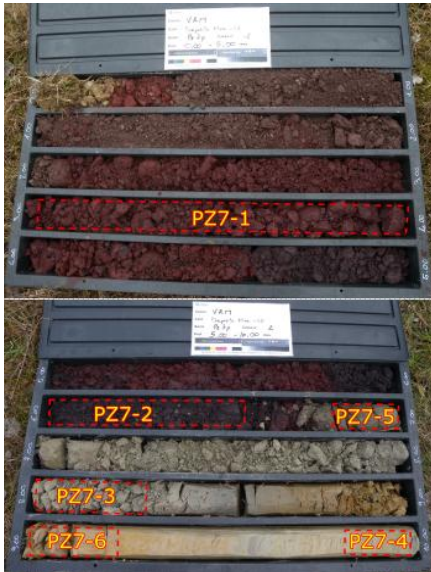
Figura 4. Stratigrafia del piezometro PZ7 visibile attraverso le cassette di carotaggio utilizzate per stoccare i campioni. Le aree tratteggiate indicano le porzioni di sedimento che sono state raccolte per eseguire due analisi rappresentative delle ceneri e di tutte le tipologie di sedimento attraversato. Le analisi multi-tecnica hanno richiesto la raccolta di volumi anche significativi di sedimento (vedi testo).
